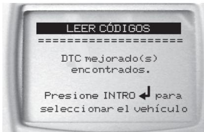
Después de seleccionar ENTER (!Intro), debe seleccionar los detalles específicos del vehículo que se está escaneando actualmente.
